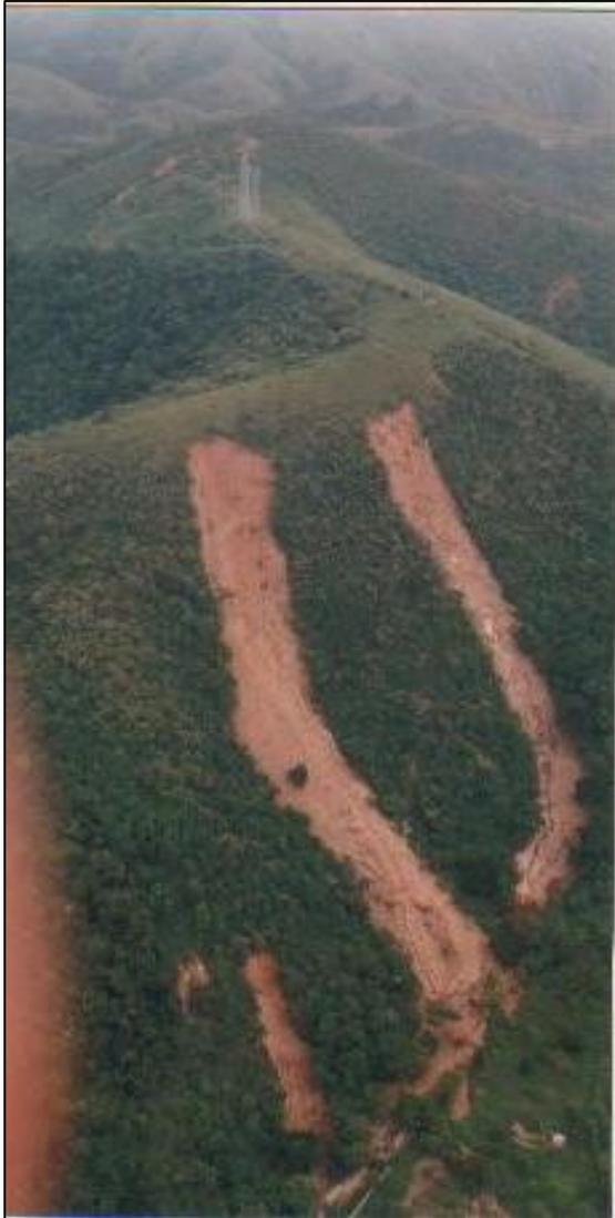
*Foto – Deslizamento translacional de solo residual seguido de corrida de terra que atingiu a via.*
