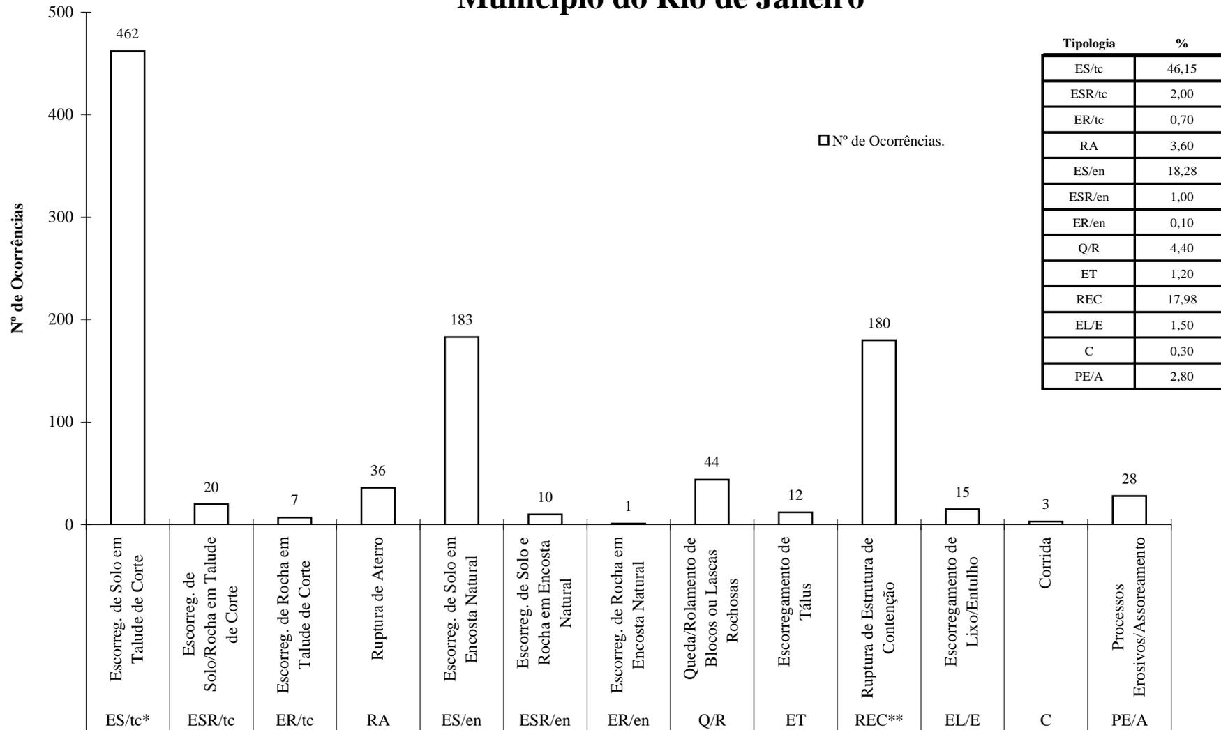
\*Em geral, tratam-se de cortes em talude realizados por moradores e sem qualquer embasamento técnico, sendo portanto estruturalmente instáveis e, por consequência, muito susceptíveis a escorregamentos;
